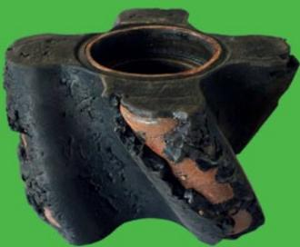
Alter beschädigter Kolben
